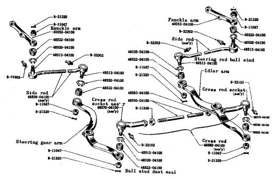
Fig. 6 Steering linkage
